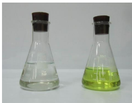
Figura b. Tras un tiempo, el azul de metileno se reduce, por lo que queda incolora la disolución y el que contenía 4-nitrofenol aparece amarillo.
