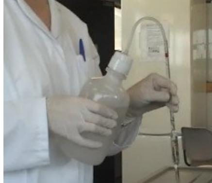
**Lavado de pipeta por arrastre con agua desionizada**
